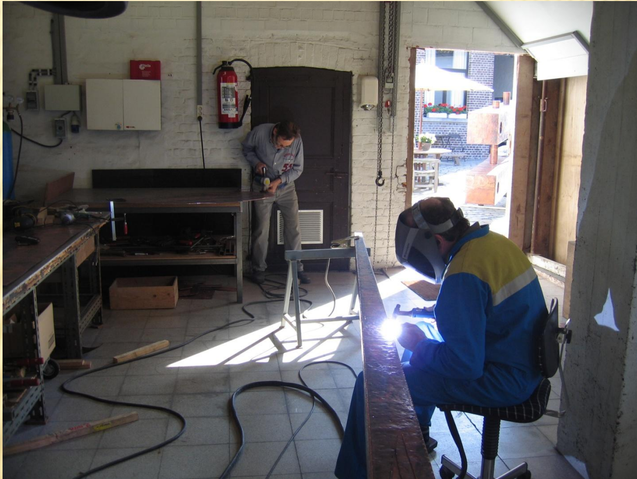
Het lassen van de stijl
